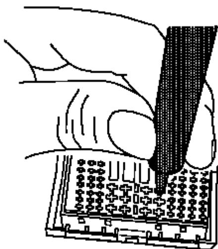
5.用端子拆卸工具J-38125-566,在待拆卸端子的每一侧,将突起压入孔内,从而松开锁紧凸舌,并将端子拉出连接器体。
