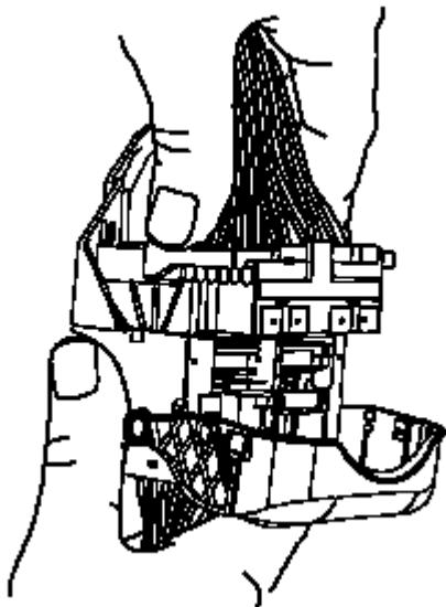
2.锁杆在90度位置，插头连接器体分离后，它可以向外滑，以便拆卸。
