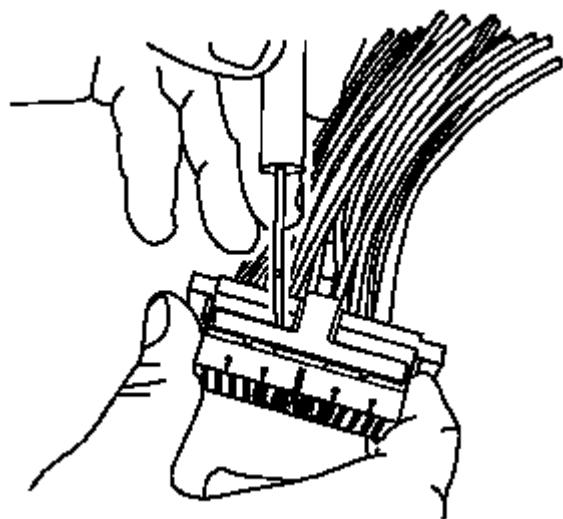
注意:在装配过程中,如果任何端子没有完全固定,端子定位器 (TPA) 将不会完全固定。
