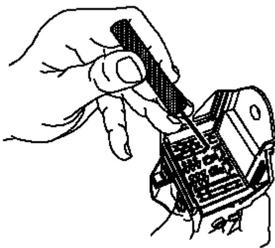
12. 使用端子拆卸工具J-38125-216，越过端子，将端子板从连接器体孔提起。
