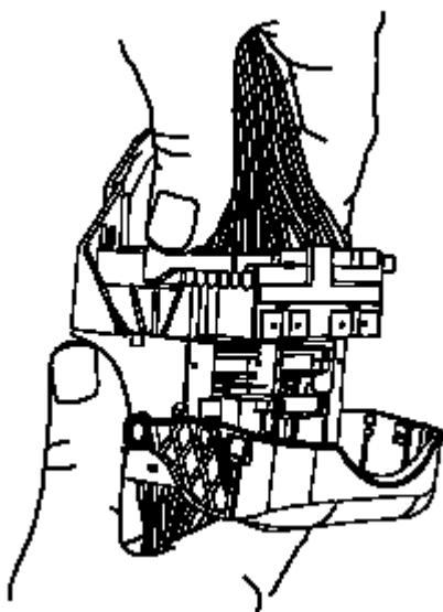
20.锁杆在90度位置，插头连接器体连接后，它可以向内滑入，以便组装。
