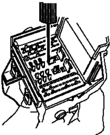
17.把端子板压回插座连接器上的预设位置。板件将会在各拐角处稍微有点卡滞。
