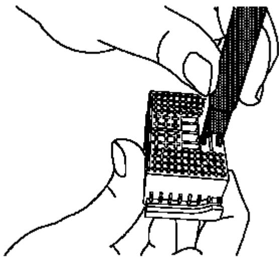
7.用端子拆卸工具J-38125-221，在待拆卸端子的每一侧，将突起压入孔内，从而松开锁紧凸舌，并将端子拉出连接器体。
