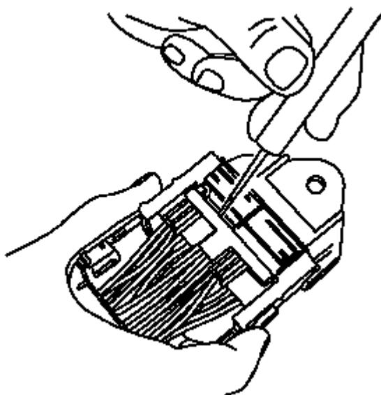
注意:在装配过程中, 如果任何端子没有完全固定, 端子定位器不会完全固定。
