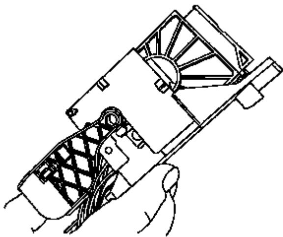
18.锁杆在180位置，对准导板，与锁杆上的轮齿相啮合。
