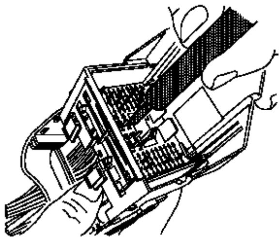
15.用端子拆卸工具J-38125-212，在待拆卸端子的每一侧，将突起压入孔内，从而松开锁紧凸舌，并将端子拉出连接器体。
