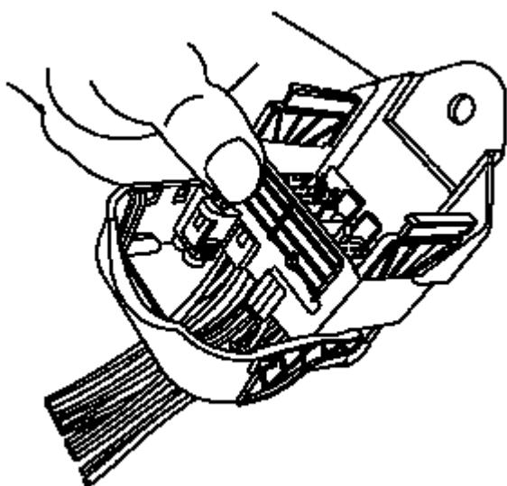
8.插座连接器体可能有一个附加的连接器钩在壳体的边缘。用端子拆卸工具J-38125-11A或同等工具，松开锁舌，并将连接器从母体上滑出。
