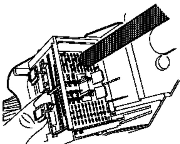
16.用端子拆卸工具J-38125-560，在待拆卸端子的每一侧，将突起压入孔内，从而松开锁紧凸舌，并将端子拉出连接器体。
