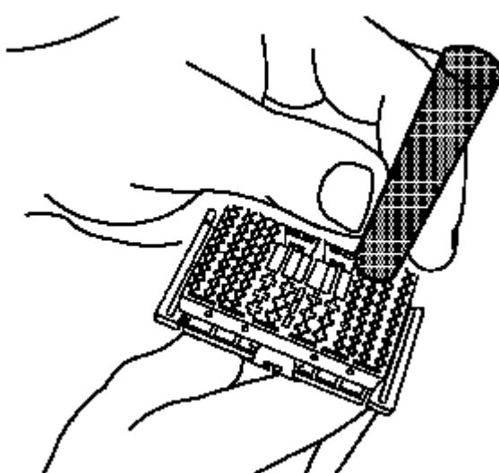
6.用端子拆卸工具J-38125-560,在待拆卸端子的每一侧,将突起压入孔内,从而松开锁紧凸舌,并将端子拉出连接器体。
