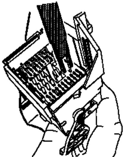
14.用端子拆卸工具J-38125-221，在待拆卸端子的每一侧，将突起压入孔内，从而松开锁紧凸舌，并将端子拉出连接器体。
